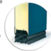
Avec ses 82 mm d'isolation et ses doubles joints multi-lèvres, la porte sectionnelle OH1082P réduit son coefficient U à 0,46 W/m<sup>2</sup>K, porte de 5 x 5 m complète.
